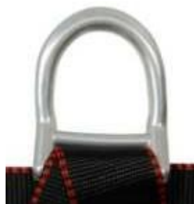
Рис. 4 Деформированная страховочная точка на привязи после падения
