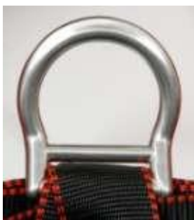
Рис. 3 Новая страховочная точка до приложения нагрузки
