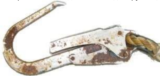
Рис. 8 Карабин, имеющий следы глубокой коррозии, а также отсутствующую пружину
