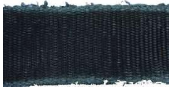
Рис.2 Пример ленты с потертостями и надрывами краев
