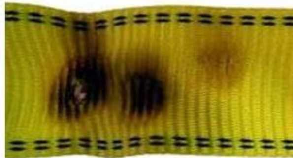
Рис.10 Лента со следами огневого поражения
