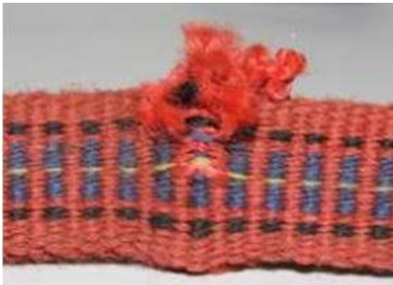
Рис.9 Лента с надорванным краем
