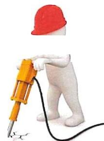
234. Натягивать и перегибать шланги пневматического инструмента во время работы запрещается. Не допускается также пересечение их тросами, кабелями и рукавами газосварки.
