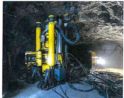
34. Во время бурения необходимо следить за исправностью бурового станка и за состоянием его крепления в выработке, правильной ориентацией бурового инструмента, эффективностью работы средств пылеулавливания. Управлять станком необходимо с пульта управления.
