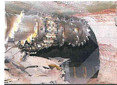
21. Если при спуске или подъеме комбайна на холостом ходу произошло нарушение крепи, горнорабочий обязан потребовать немедленной остановки машины, восстановить нарушенную крепь, убрать обрушенный уголь и породу. На наклонных пластах при подъеме машины в первом ряду необходимо установить несколько предохранительных полков.
