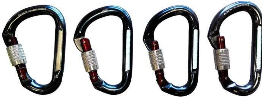
Рис. 7 Новый карабин и последовавшая под нагрузкой деформация
